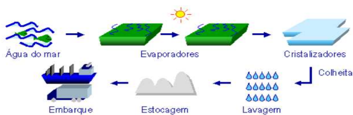
Figura 3: Processo de produção do sal marinho
